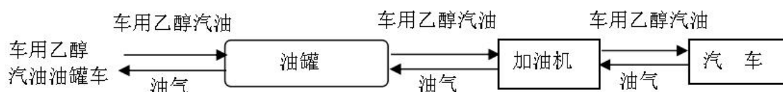
图 2-3 车用乙醇汽油加油工艺流程框图
