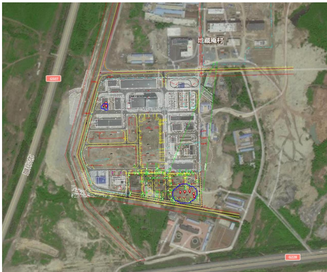
图 8.3.2-1 个人风险模拟曲线图（提示：一级风险，二级风险，三级风险曲线重合）
