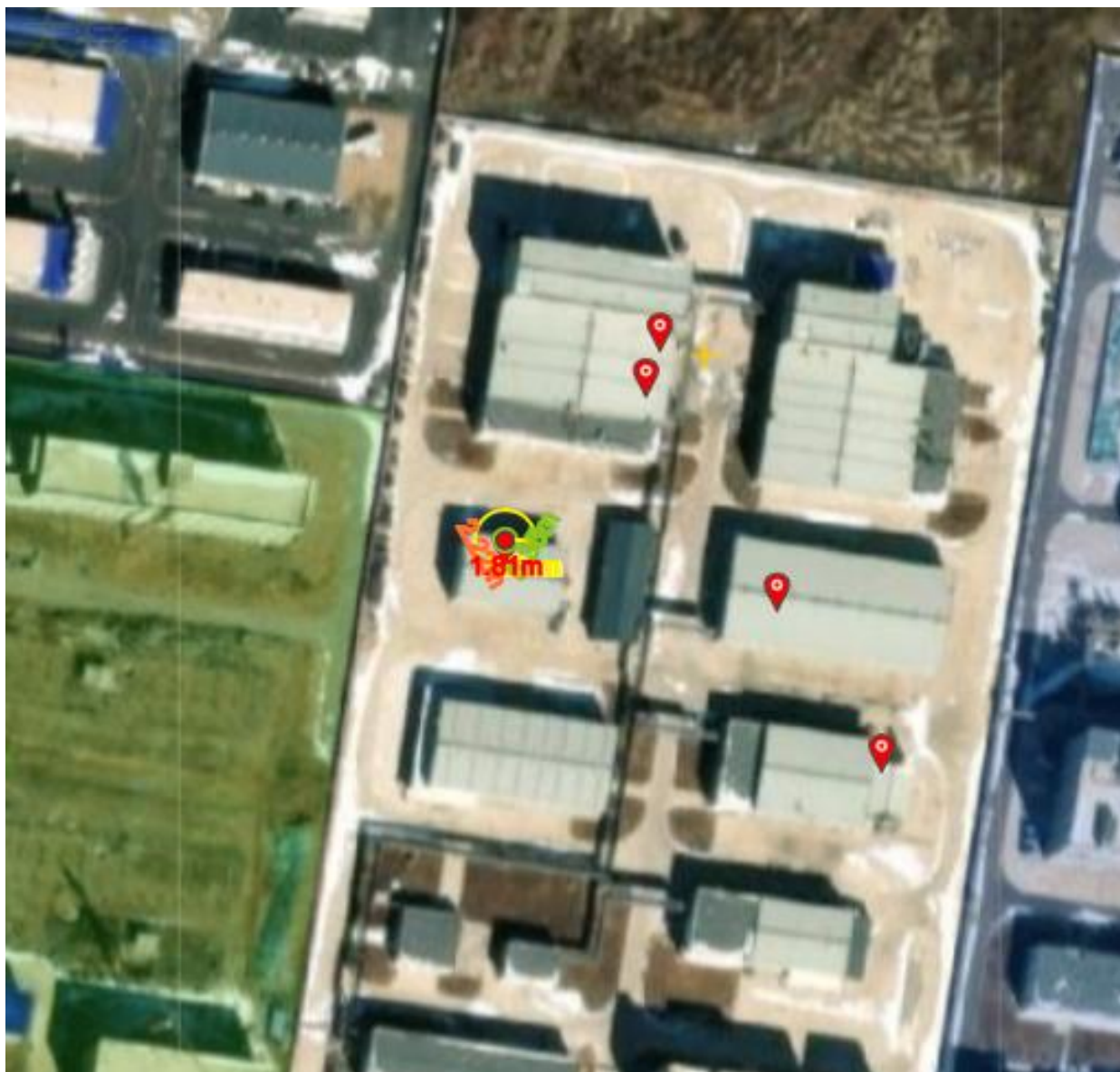
图 F3.3-7 氢气罐喷射火事故影响模拟
