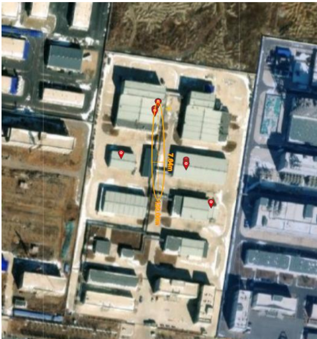
图 F3.3-1 硒化氢有毒有害物质泄漏扩散事故影响模拟
