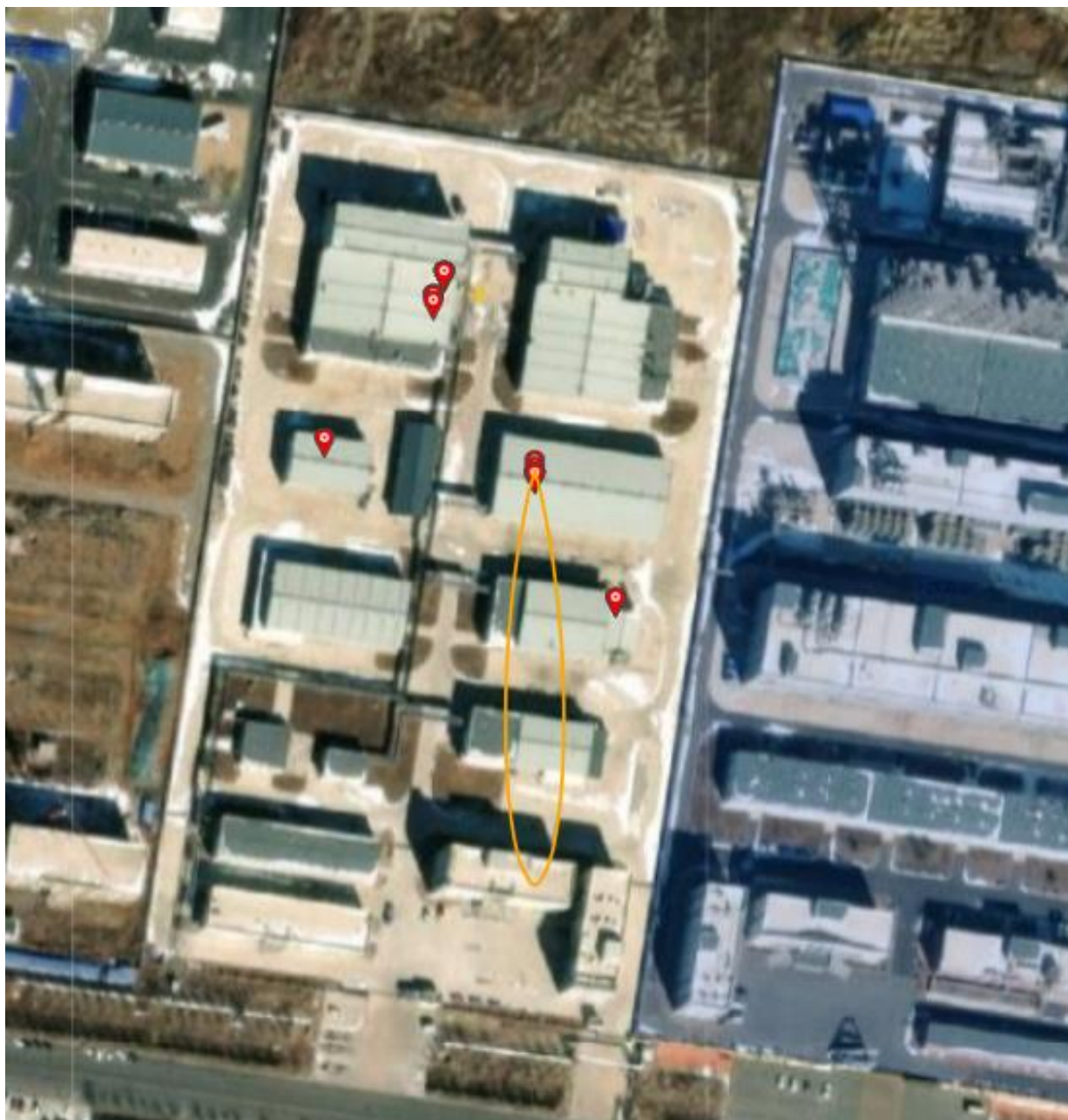
图 F3.3-6 仓库二四氧化二氮泄漏事故影响模拟
