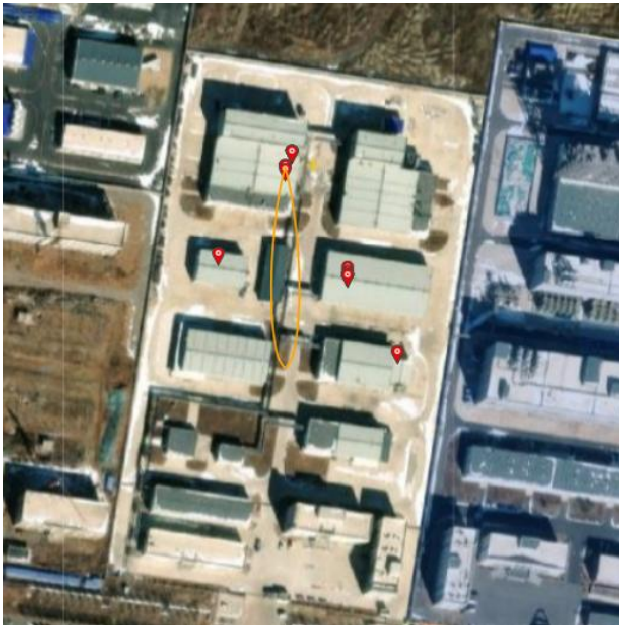
图 F3.3-5 绿氮装置四氧化二氮泄漏中毒事故影响模拟
