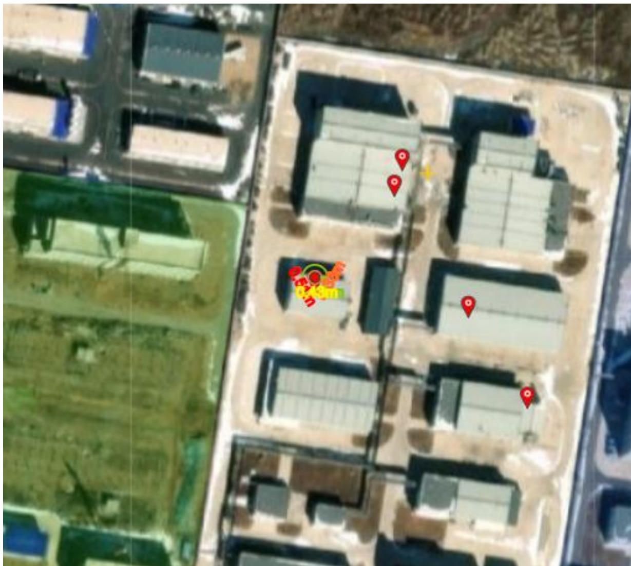
图 F3.3-8 氢气罐爆炸事故影响模拟
