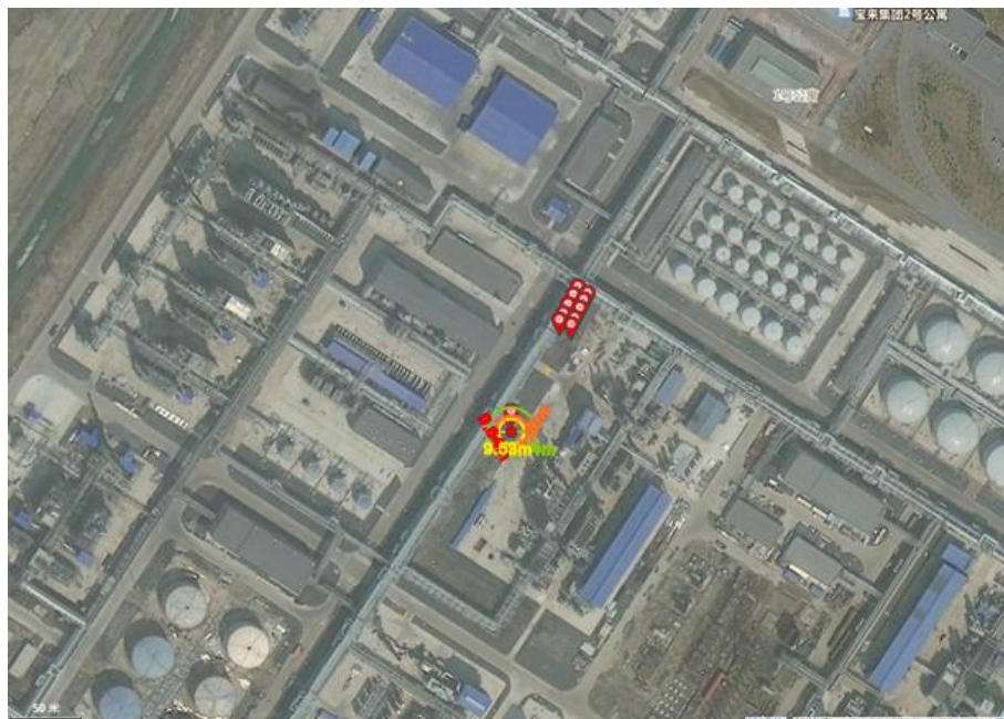
附件图 F2. 3-5 解析气压缩机喷射火事故后果模拟图
