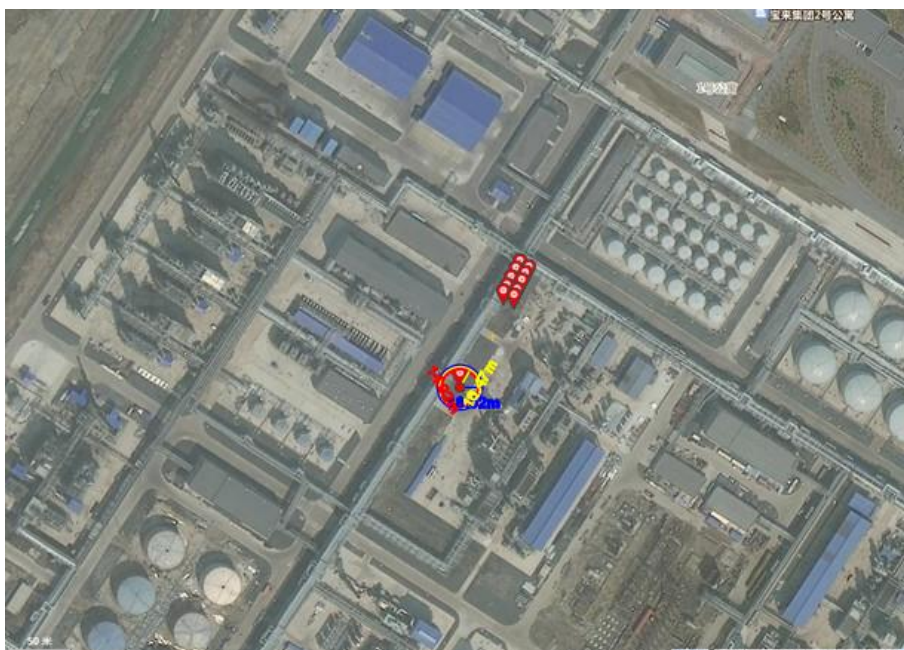
附件图 F2. 3-10 解吸气压缩机外部安全防护距离
