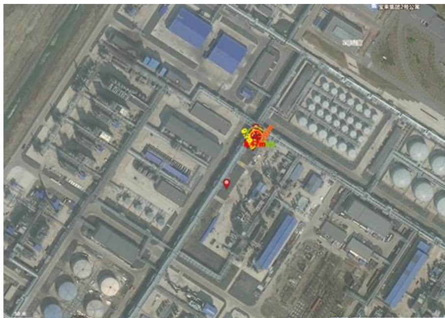
附件图 F2. 3-1 低分气 PSA 提氢设施吸附过程喷射火事故后果模拟图
