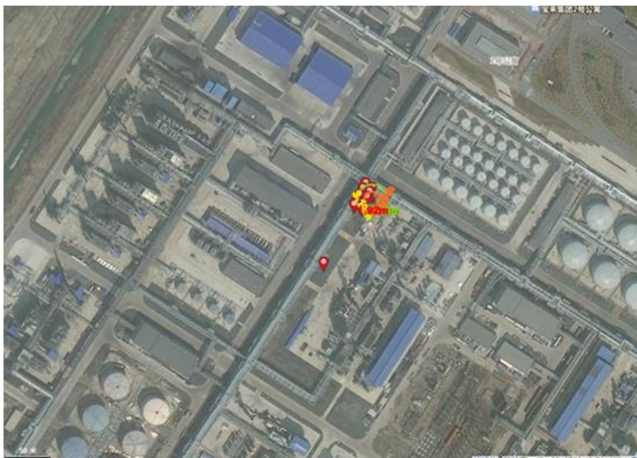
附件图 F2.3-4 低分气 PSA 提氢设施解吸过程蒸汽云爆炸事故后果模拟图
