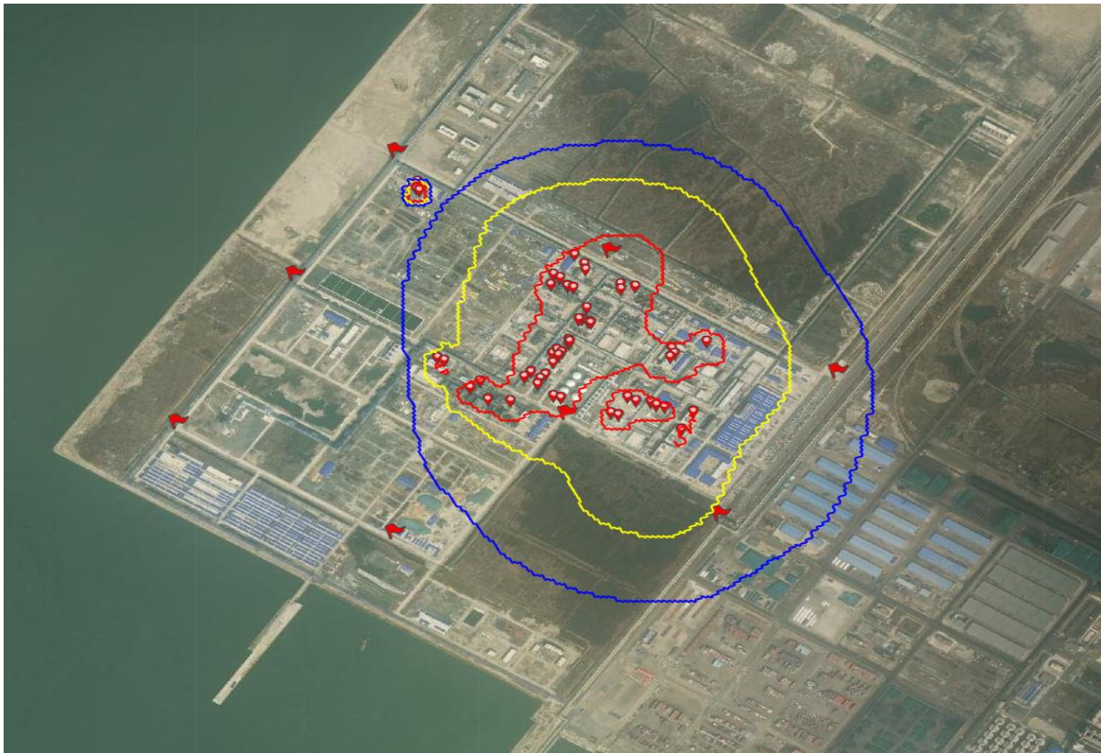
图 B.0.3-3 个人风模拟曲线图（GB 36894-2018）
