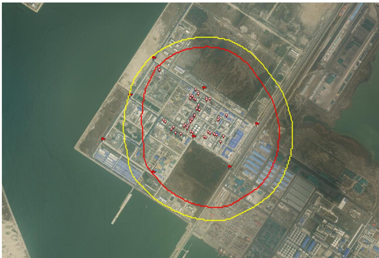
图 B.0.3-4 个人风险模拟曲线图（40 号令）
